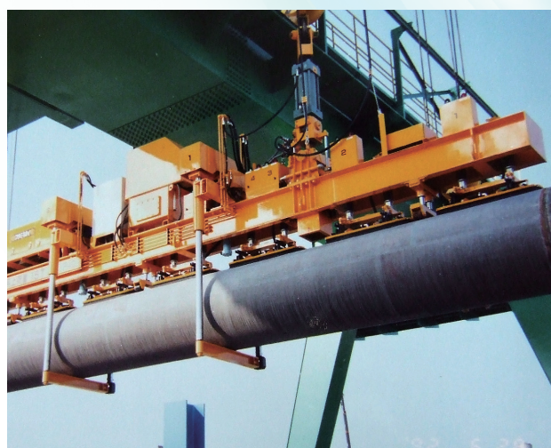
鋼管用 バキュームリフト (18.3t 吊り)
