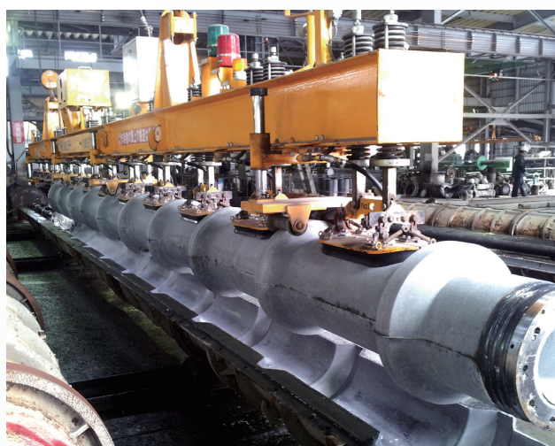
コンクリートパイプ用 バキュームリフト (10t 吊り)
